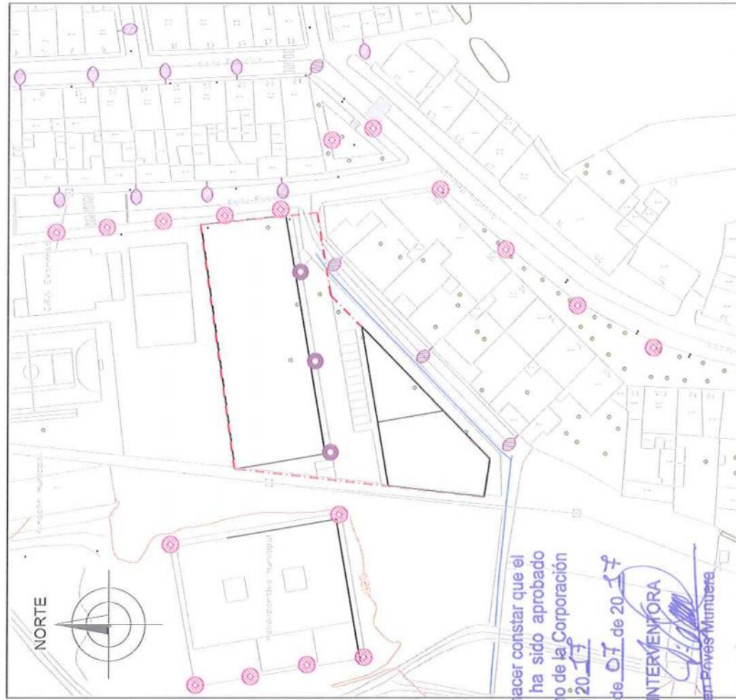
RED DE ALUMBRADO PUBLICO (ESTADO REFORMADO) ESCALA: 1/1000
